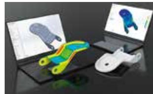
Alors que la qualification de produits nécessite la production de prototypes et donc une conception avancée des produits avec des coûts d'essais importants, la simulation permet de faire de nombreux essais à travers la mise au point de prototypes virtuels.
